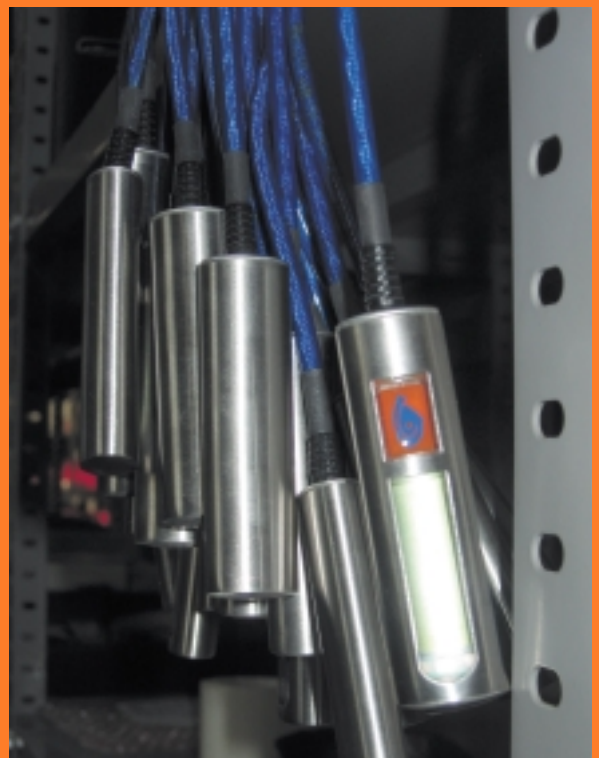
Assemblage de l'unité de contrôle sur son câble de connexion "technologie 2 fils". On distingue également le renfort au Kevlar.
